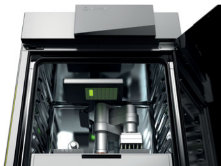
Fokusansicht auf LED-Matrix und Pipettierkopf
